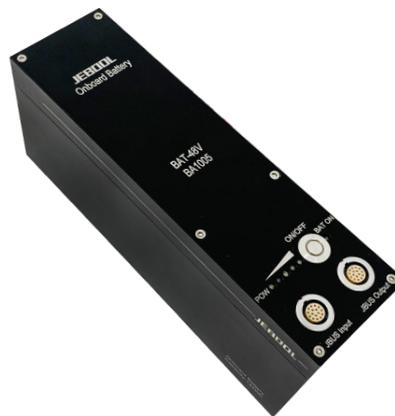
车载电池 BAT-48V，采用功率型锂电芯设计，充满电时 54V，放电截至电压为 36V。内置了 UPS 自动旁路电路，当外部电源大于 24V 时（默认值，可定制该阈值），自动切换为外部电源供电；当外部电压大于 30V 时，将自动对电池进行充电，同时外部电源也作为输出电压直接向负载供电；电池最大充电电流 1.2A，支持外部电源最大输入电压 54V。设备内置电池均衡和温度保护功能，电池输出指示灯和电量显示指示。
