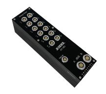
车载气囊定时点爆器,主要应用于汽车碰撞试验或模拟台车试验中气囊(发生器)的定时点爆。AT-12C 和 AT-8C 分别采用 12 通道和 8 通道设计;每个通道均可独立设置,并且通过各自的指示灯,实时显示连接气囊状态。设备内置 UPS 电池及各通道独立的点爆电容,同时可对点爆电流和电压进行数据采集。外部采用 JBUS 总线连接,并设置有独立的触发输入口,整体操作简单。
