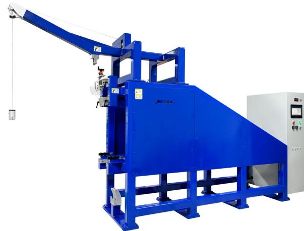
动态标定设备（以下简称“设备”）是根据 C-NCAP 和 ECE R127 相关要求进行设计的汽车碰撞测试用腿型标定设备。设备可兼容 aPLI 和 Flex-PLI 两种腿型的动态标定。设备采用模块化设计，用于腿型悬挂的模块可快速调整高度以适应 aPLI 膝部、大腿和 Flex-PLI 的冲击标定。悬挂模块具有高度微调功能，以适应不同腿型之间存在的尺寸公差。设备采用高精度直线伺服驱动小车，小车撞击速度精准稳定。用于 Flex-PLI 摆锤标定的模块使用伺服电机驱动，可自动提升至指定角度。设备采用软件自动控制，标定报告自动生成，报告模板可按要求定制。
