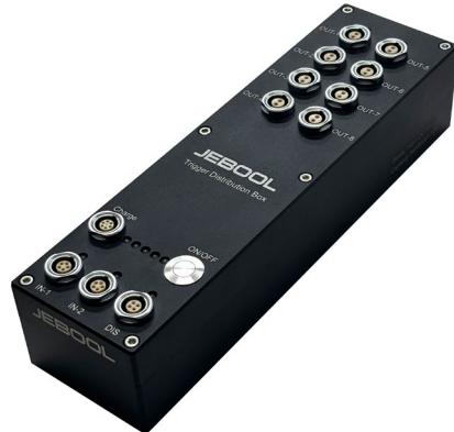
触发分布器 TRG-8S，主要为汽车碰撞试验设计，可车载使用，也可用于汽车零部件试验时的多路同步触发。触发输入通常接带状开关或光电开关。触发输出接数采、气囊点爆器、相机等。内部 8 通道全部光电隔离。TRG-8S 内置了锂电池，其 UPS 功能增加了触发的可靠性。
