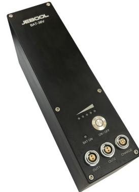
车载电池 BAT-36V，采用功率型锂电芯设计，具有较高满电电压，较低放电截至电压。内置了 UPS 自动旁路电路，当外部电源大于设置旁路阈值时，自动切换为外部电源供电；当外部电压大于充电阈值时，将自动对电池进行充电，同时外部电源也作为输出电压直接向负载供电；电源传递的最大电流为 10A（每个输出口为 5A），支持外部电源最大输入电压 50V。设备内置电池均衡和温度保护功能，电池输出指示灯和电量显示指示。
