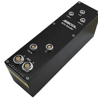
ACU 发送器 ACU-3C 主要应用于台车或整车碰撞试验中，模拟 ACU 对基于 CAN 总线和 PWM 协议的部件（如安全带总成）进行功能验证，进而快速对车辆进行开发。CAN 报文和 PWM 的发送，可基于 ARM, T0, 数字量输入等标记，进行单次或循环报文发送。提供命令编辑软件，试验时可脱机自动执行。设备内置了锂电池并具有 UPS 功能。并采用了 JBUS 总线结构，方便与其他设备连接和功能扩展。
