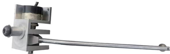
H3CHP-ASS 专用于 H3 假人用胸部位移测量，其核心采用高性能电阻式电位计，具有出色的非线性度，保证了整个组件位移测量的准确性。电位计和安装组件采用定位销定位，并通过锁紧螺母固定，防止电位计滑动影响灵敏度。可根据 H3-5<sup>TH</sup> 和 H3-50<sup>TH</sup> 假人，提供配套规格。默认线长 8 米，可按客户要求提供接头和 ID 芯片。另外可提供数字化 DDAS 版本。
