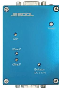
信号调理器 BR-SC1A 应用于毫伏或微伏级电压信号放大，特别是传感器信号的精密调理，同时保持高的信号传输带宽。对于应变式桥路及压阻类型传感器，提供了带补偿的精密激励电压。同时，BR-SC1A 内置了电源滤波模块，有效抑制了外部电源恶劣时的干扰。
