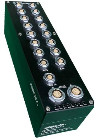
数据采集器 JDAS-AS16 采用抗冲击设计，可用于台车和整车碰撞试验。具有 16 通道传感器输入，支持电压直接输入，PR 和应变桥路输入。其内置了可充电锂电池和断电不丢失的 Flash 存储器；同时提供了软件 Start Recording 触发，外部 SR 和 T0 开关触发和模拟量阈值触发，保障了试验简单可靠。
