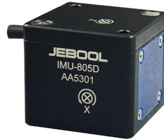
IMU-805D 集成了 3 轴加速度和 3 轴角速度，以及 6 通道的 ADM 数字化模块，实现了 IMU 数据一体化采集，通过 DDAS 总线控制和数据传输。其内部包括一个高精度 LDO 稳压和硬件抗混叠低通滤波电路，实现了加速度和角速度信号的精密测量。IMU-805D 配有高性能耐磨线缆，通过 2 个安装孔来固定，可以根据客户需要，来配置接头。
