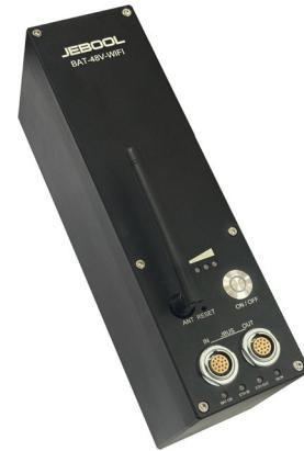
车载电池 BAT-48V-WIFI, 为 JBUS 总线或兼容总线设备设计, 在满足高功率电源输出的同时, 实现 JBUS 总线以太网至无线 WLAN 的转换。内置了 UPS 自动旁路电路, 当外部电源大于旁路阈值时, 自动切换为外部电源供电; 当外部电压大于充电阈值时, 将自动对电池进行充电, 同时外部电源也作为输出电压直接向负载供电。
