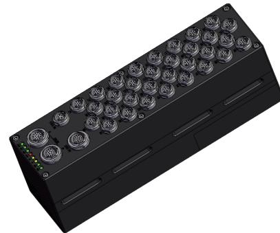
数据采集器 JDAS-32C 采用抗冲击设计，可用于台车和整车碰撞试验。具有 32 通道传感器输入和 16 通道数字量输入，支持电压直接输入，PR 和应变桥路输入。其内置了可充电锂电池和断电不丢失的 Flash 存储器；支持软件 Start Recording 触发，硬件外部 SR 和 T0 开关触发和模拟量阈值触发。
