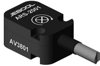
角速度传感器 ARS-2001 基于谐振器陀螺仪原理，内部包含多个振动构架，当检测结构旋转时，产生的科氏力来改变一个电容结构，进而转换为电信号变化，从而实现了角速度测量。独立的供电与测量系统完全隔离，直接输出电压信号与被测电流有较好的线性关系。ARS-2001 配有高性能耐磨线缆。另外，可以根据客户需要，配好 Dallas ID 和接头。
