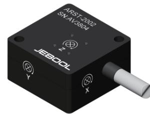
三轴角速度传感器 ARST-2002 基于谐振器陀螺仪原理，内部包含多个振动构架，当检测结构旋转时，产生的科氏力来改变一个电容结构，进而转换为电信号变化，从而实现了角速度测量。独立的供电与测量系统完全隔离，直接输出电压信号与被测电流有较好的线性关系。ARST-2002 配有高性能耐磨线缆，以及 6 个用于安装加速度（3 个 7264）的孔位。另外，可以根据客户需要，配好 Dallas ID 和接头。
