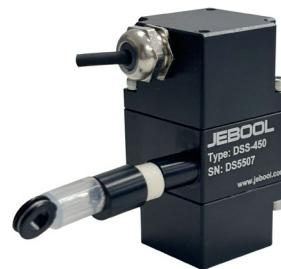
拉线位移传感器 DSS-450，内部包含一个可调电位计，并同轴设计钢丝线圈，当钢丝拉伸或收缩时，电位计阻值随之变化，并保证位移量与输出电压的良好线性关系。钢丝采用 304 不锈钢包胶，加上内部强力的弹簧结构，保证了高速响应能力。传感器配有高性能耐磨线缆，安装可以使用螺丝固定。
