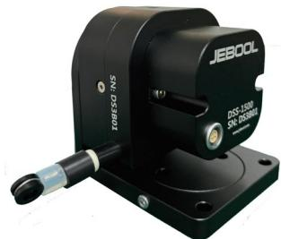
位移传感器 DSS-1500，内部包含一个可调电位计，并同轴设计钢丝线圈，当钢丝拉伸或收缩时，电位计阻值随之变化，其内部独特的设计，使得位移量与输出电压保持了良好的线性关系。钢丝采用 304 不锈钢材料，及大张力设计，非常适用于高速测量应用，如汽车碰撞假人移动，保险杠溃缩量，以及航空机载设备状态监测。
