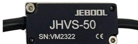
电压传感器 JHVS-50，用于实现对车辆上电瓶电压的测量，低压电气设备碰撞试验过程中实时状态监测等。传感器采用低温漂除法电路，实现信号的输出与电压的输入线性关系，同时满足数据采集设备的信号要求。默认量程 $\pm 50V$ ，其他量程可定制（小于 100V）。该传感器内部对电源和信号全隔离。传感器拥有可靠的短路保护措施，体积小，精度高。
