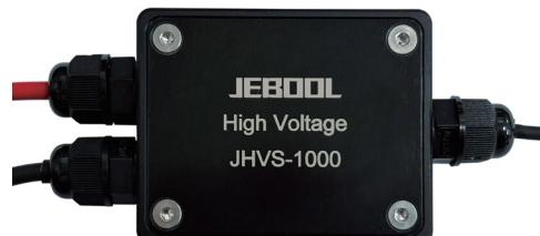
电压传感器内部设计对称降压结构，采用高精度多级降压电路，同时构建超过 1500V 的隔离电路能力。测量精度高，响应时间快，结构稳定可靠，可广泛应用于电动汽车或混动汽车的各种电压检测，特别是碰撞试验过程中动力电压变化监测。JHVS-1000 配有高绝缘性线缆，接口形式可定制。信号端采用耐磨线缆与数据采集设备连接，长度可以定制。另外，可以根据客户需要，配好 Dallas ID 和接头。
