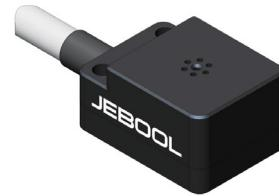
压力传感器 DP50K 基于压阻原理，内部包含一个全桥电路，以大气压作为零点，当检测到外部气压变化时，内部桥路电阻发生变化，进而转换为电信号变化，从而实现气压测量。内部可靠精密的 MEMS 工艺，保证了输出电压信号与被测电流有较好的线性关系。DP50K 配有高性能耐磨线缆，可以用双面胶粘接也可以使用螺丝或铆钉来固定。另外，可以根据客户需要，配好 Dallas ID 和接头。
