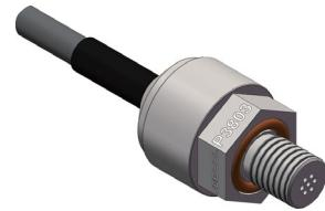
压力传感器 AP1000K 基于压阻原理, 内部包含一个全桥电路, 当检测到外部气压变化时, 内部桥路电阻发生变化, 进而转换为电信号变化, 从而实现气压测量。内部可靠精密的 MEMS 工艺, 保证了输出电压信号与被测电流有较好的线性关系。AP1000K 配有高性能耐磨线缆, 采用 M5×0.5 螺纹安装, 端部橡胶圈密封。另外, 可以根据客户需要定制不同安装螺纹。
