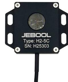
氢气传感器通过测量气体混合物热导率的改变来检测空气中的氢气浓度。氢气和空气的热导率差异很大，氢气浓度的变化会导致气体混合物热导率的显著变化。传感器集成了湿度和气压传感器，以补偿因为环境变化引起的导热系数变化，从而获得稳定可靠信号。传感器配有高性能耐磨线缆，长度可以定制，可配 Dallas ID 和接头。
