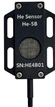
氦气传感器基于气体导热原理，实现空气中氦气浓度的检测。其内部使用的气体导热传感器，采用 MEMS 加工技术，利于被测组份和参考气体的导热响应。传感器内部运用运放反馈和偏置电路，减少了温度对信号的影响，改善了传感器的线性度。传感器配有高性能耐磨线缆，长度可以定制。可选配 Dallas ID 和接头。
