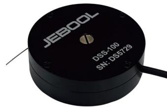
位移传感器 DSS-100，内部包含一个可调电位计，并同轴设计钢丝线圈，当钢丝拉伸或收缩时，电位计阻值随之变化，其内部独特的设计，使得位移量与输出电压保持了良好的线性关系。钢丝采用 304 不锈钢材料，及大张力设计，非常适用于高速测量应用，如汽车碰撞试验中零部件移动，以及航空机载设备状态监测。
