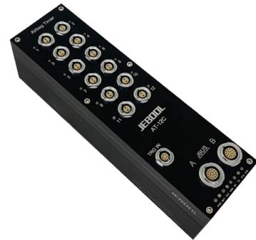
车载气囊定时点爆器，主要应用于汽车碰撞试验或模拟台车试验中气囊（发生器）的定时点爆。AT-12C 采用 12 通道设计；每个通道均可独立设置，并且通过各自的指示灯，实时显示连接气囊状态。设备内置 UPS 电池及各通道独立的点爆电容，同时可对点爆电流和电压进行数据采集。外部采用 JBUS 总线连接，并设置有独立的触发输入口，整体操作简单。
