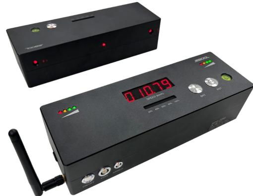
速度测量系统 SPS-20M 采用高速、远距离激光传感器，前后 2 组对射安装。通过检测物体穿过 2 组激光传感器的时间差，来计算速度。使用时，通过可见光斑及 LED 显示来进行位置调整。测速仪支持无线复位功能，启动后即进入 ARM 状态，当物体进入传感位置即触发测量，通过后立即显示速度结果。测速仪 SPS-20M 可提供导轨或三脚架安装支架，非常方便安装和位置调整。
