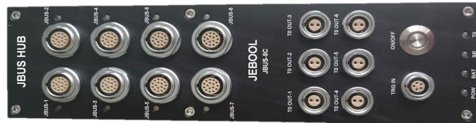
车载交换机 JHUB-8C, 主要应用于汽车碰撞试验中, 对内置数采假人 (In-Dummy), 车载高速相机等进行总线集成, 包含供电, 通信及触发信号传递, 从而极大简化测量系统。JHUB-8C 同时提供触发输出, 实现与碰撞试验中车载数采, 电测量等设备进行同步数据采集。JHUB-8C 内置 UPS 电池, 保证通信及触发的可靠性; 独立的触发输入, 可接外部开关实现 Start Recording 和 T0 触发。
