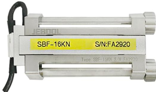
安全带张力传感器基于全桥应变原理，将安全带的内部张力传递到传感器结构，结构的应变使应变计电阻变化，进而实现对安全带张力的电信号测量。传感器主体结构采用钛合金材料，以减少其重量对其他的影响。SBF-16kN 配有高性能耐磨线缆，线缆长度可以定制。另外，可以根据客户需要，配好 Dallas ID 和接头。
