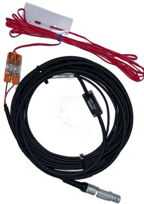
应变传感器 JSG-120R 基于应力应变原理，包含一个可选应变片。应变桥盒内有匹配应变片的电阻，组成全桥电路，输出信号。默认线长 8m，默认不含接头及 Dallas ID。
