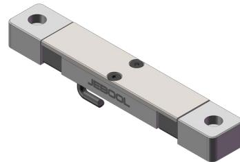
ES2 假人单轴腹部力传感器 DLC-2231 基于全桥应变原理, 将传感器轴向力, 转换为应变量, 结构的应变使应变计电阻变化, 进而实现对力的电信号测量。传感器主体结构采用特种钢材, 并配有高性能耐磨线缆, 线缆长度可以定制。另外, 可以根据用户需要, 配好 Dallas ID 和接头。
