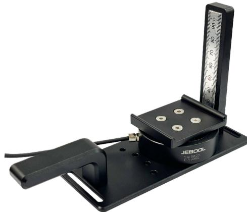
安全带压力传感器，采用高精度传感器单元，配合夹具组合，方便安全带对假人的压力测量。夹具配置了一个高度尺，方便测量安全带拉起高度。试验中，可根据需要对安全带压力传感器的部件进行拆解，保留需要的部分，以满足应用要求。传感器配耐磨屏蔽线缆，可选择配置数显表或数据采集器。
