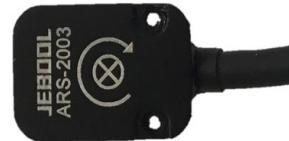
角速度传感器 ARS-2003 基于谐振器陀螺仪原理，内部包含多个振动构架，当检测结构旋转时，产生的科氏力来改变一个电容结构，进而转换为电信号变化，从而实现了角速度测量。独立的供电与测量系统完全隔离，直接输出电压信号与被测电流有较好的线性关系。ARS-2003 配有高性能耐磨线缆。另外，可以根据客户需要，配好 Dallas ID 和接头。
