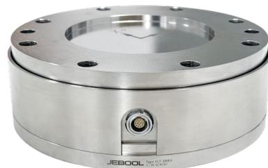
三轴力传感器 LCT-100KA 基于全桥应变原理，将传感器两个端面上的三向力，转换为应变量，结构的应变使应变计电阻变化，进而实现对力的电信号测量。传感器主体结构采用不锈钢材料，并配有高性能耐磨线缆，线缆长度可以定制。另外，可以根据用户需要，配好 Dallas ID 和接头。
