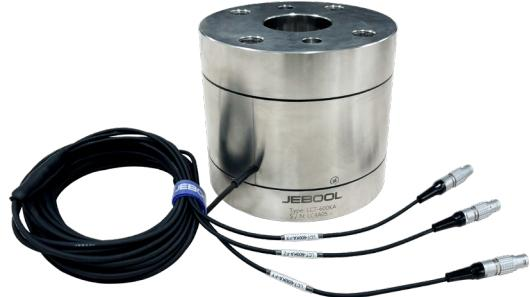
三轴力传感器 LCT-500KA 基于全桥应变原理，将传感器两个端面上的三向力，转换为应变量，结构的应变使应变计电阻变化，进而实现对力的电信号测量。传感器主体结构采用不锈钢材料，并配有高性能耐磨线缆，线缆长度可以定制。另外，可以根据用户需要，配好 Dallas ID 和接头。
