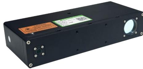
位移传感器 DSL-1300，采用可见红光三角法测量，将一束细小激光，投射到被测物体表面，并在表面形成反射，反射后再进入激光位移传感器内部。通过内部算法计算目标距离。传感器具有实时高速计算的能力，并且具有极短的进入反射距离建立时间；同时该激光位移传感器可以自适应多种物体反射表面，对于粗糙特别恶劣的反射表面，也可通过粘贴反光板来改善。
