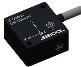
G-Motion 用于运动数据采集，通过集成多个加速度和角速度冗余结构和自适应状态机构架，实现运动加速度和角速度的精确测量。该单元可通过改变内部寄存器设置，来修改测量范围，来满足不同应用需要，如飞行器姿态测量，倾角测量，汽车碰撞试验中物体运动。其内部包括一个高精度 LDO 稳压，和温度自动补偿功能，进一步减少了测量环境干扰。G-Motion 配有高性能耐磨线缆，通过 2 个安装孔来固定，可以根据客户需要，来配置接头。
