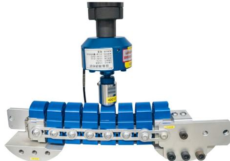
静态标定设备（以下简称“设备”）是根据腿型厂家和 ECE R127 相关要求进行设计的汽车碰撞测试用腿型标定设备。设备可兼容 aPLI 和 Flex-PLI 两种腿型的静态标定。设备主要包括电子万能试验机，参考力传感器，参考位移传感器，数据采集装置，传感器信号转接盒，标定夹具和操作软件。
