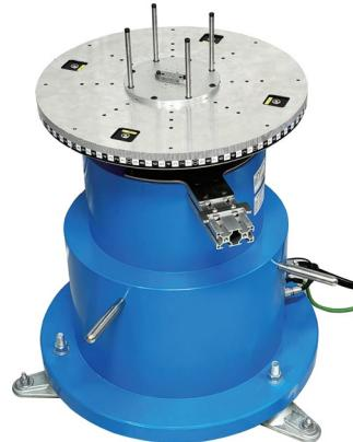
角速度传感器标定系统主要有速率转台和数据采集装置构成, 速率转台按照《GJB 1728A-2019 速率转台通用规范》标准进行设计, 主要由机械台和测控系统两大部分组成。该标定系统具有位置、速率运动功能, 为被测传感器提供定位及速率基准。系统参考《JJF 1535-2015 微机电 (MEMS) 陀螺仪校准规范》实现大量程惯性部件的静态测试和标定, 其台面尺寸Φ450mm, 总高约 500mm。系统采用软件自动控制, 标定报告自动生成, 报告模板可按要求定制。
