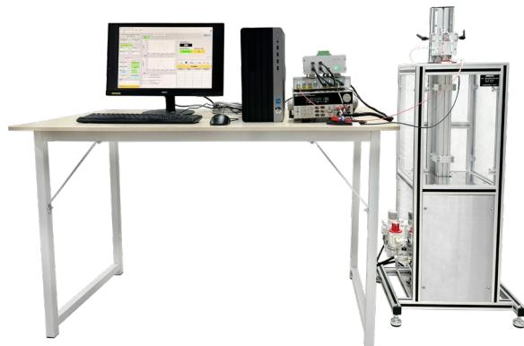
加速度传感器冲击标定系统 SCS-ACS，采用活塞气动冲击原理产生物理加速度，并参考 ISO16063-22 标准进行设计。在软件自动控制下，通过控制冲击压力和气阀开关，获得 30g~2000g 的半正弦加速度峰值。系统采用 Endevco 2270 作为参考标准加速度传感器，其谐振频率均大于 35kHz，并具有极低的温漂 (<3%，-40°C~120°C)，及长期稳定性。系统采用软件自动控制，标定报告自动生成，报告模板可按要求定制。
