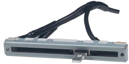
推杆式位移传感器 WY-40，主要包含一个滑动电位计。当滑片移动时，电位计阻值随之变化，位移量与电阻变化率有良好的线性关系。通过欧姆定律，转换为电信号后，从而实现位移测量。另外，可以根据客户需要，配好 Dallas ID 和接头。
