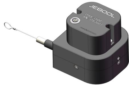
位移传感器 DSS-1500，内部包含一个可调电位计，并同轴设计钢丝线圈，当钢丝拉伸或收缩时，电位计阻值随之变化，其内部独特的设计，使得位移量与输出电压保持了良好的线性关系。钢丝采用 304 不锈钢材料，及大张力设计，非常适用于高速测量应用，如汽车碰撞假人移动，保险杠溃缩量，以及航空机载设备状态监测。
