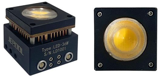
车载补光灯 LED-36W 采用大功率 LED 矩阵式灯珠，实现了较高的电流至光通量转换效率。LED 矩阵直接安装在铜柱式散热器上，加上高速风扇，实现了良好的散热效果。
