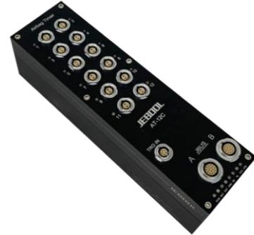
车载气囊定时点爆器，主要应用于汽车碰撞试验或模拟台车试验中气囊（发生器）的定时点爆。AT-12C 采用 12 通道设计；每个通道均可独立设置，并且通过各自的指示灯，实时显示连接气囊状态。设备内置 UPS 电池及各通道独立的点爆电容，同时可对点爆电流和电压进行数据采集。外部采用 JBUS 总线连接，并设置有独立的触发输入口，整体操作简单。
