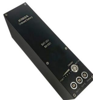
车载电池 BAT-36V，采用功率型锂电芯设计，具有较高满电电压，较低放电截至电压。内置了 UPS 自动旁路电路，当外部电源大于设置旁路阈值时，自动切换为外部电源供电；当外部电压大于充电阈值时，将自动对电池进行充电，同时外部电源也作为输出电压直接向负载供电；电源传递的最大电流为 10A（每个输出口为 5A），支持外部电源最大输入电压 50V。设备内置电池均衡和温度保护功能，电池输出指示灯和电量显示指示。
