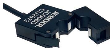
电流传感器 JCS06D 基于霍尔原理，实现对线上电流的高精度测量。独立的供电与测量系统完全隔离，直接输出电压信号与被测电流有较好的线性关系。JCS06D 配有高性能耐磨线缆，线缆长度可以定制。另外，可以根据客户需要，配好 Dallas ID 和接头。
