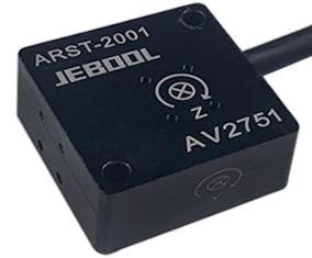
三轴角速度传感器 ARST-2001 基于谐振器陀螺仪原理，内部包含多个振动构架，当检测结构旋转时，产生的科氏力来改变一个电容结构，进而转换为电信号变化，从而实现了角速度测量。独立的供电与测量系统完全隔离，直接输出电压信号与被测电流有较好的线性关系。ARST-2001 配有高性能耐磨线缆，以及 6 个用于安装加速度（3 个 7264）的孔位。另外，可以根据客户需要，配好 Dallas ID 和接头。
