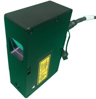
位移传感器 DSL-500，采用可见红光三角法测量，将一束细小激光，投射到被测物体表面，并在表面形成反射，反射后再进入激光位移传感器内部。通过内部算法计算目标距离。传感器具有实时高速计算的能力，并且具有极短的进入反射距离建立时间；同时该激光位移传感器可以自适应多种物体反射表面，对于粗糙特别恶劣的反射表面，也可通过粘贴反光板来改善。
