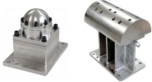
新能源汽车电池碰撞安全非常重要，特别是电池包刮底和柱碰，是发生碰撞的常见且恶劣的形式。在碰撞试验中对电池包受力情况进行了解，对车辆开发，电池包防护设计非常重要。VBB-SR75 设计用于电动汽车刮底试验壁障，采用 75mm 半径球面接触，下方可通过不同钢板厚度调整高度，来适应不同试验工况。VBB-PR127 设计用于电动汽车电池包的柱碰试验壁障，并采用了与整车柱碰壁障类似的结构设计（半径 127mm），方便加速车辆开发并节省整车试验成本。
