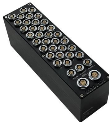
数据采集器 JDAS-32C 采用抗冲击设计，可用于台车和整车碰撞试验。具有 32 通道传感器输入，支持电压直接输入，PR 和应变桥路输入。其内置了可充电锂电池和断电不丢失的 Flash 存储器；支持软件 Start Recording 触发，硬件外部 SR 和 T0 开关触发和模拟量阈值触发。底部螺栓安装，操作简单可靠。
