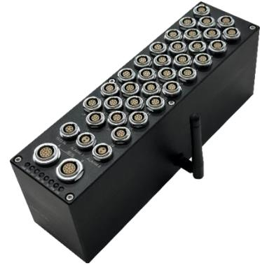
氢燃料汽车泄漏测试仪 FCV-32C 为氢燃料汽车碰撞试验中安全监测设计。试验时可通过 WiFi 实时查看数据，监测碰撞安全性。通过霍尔电流传感器隔离监测瓶阀状态。FCV-32C 支持外部开关触发及 JBUS 总线差分触发。设备与车辆储氢系统连接时，需要通过三通线缆，串接到车辆压力和温度传感器接口。同时，设备支持与氢气浓度传感器 H2-5C 或氦气浓度传感器 He-5B 连接。设备内置锂电池，支持 100Hz 数据记录及 Ethernet 数据通讯功能，数据提供多种格式。
