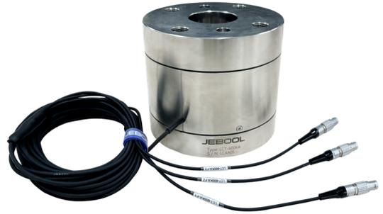
三轴力传感器 LCT-500KA 基于全桥应变原理，将传感器两个端面上的三向力，转换为应变，结构的应变使应变计电阻变化，进而实现对力的电信号测量。传感器主体结构采用不锈钢材料，并配有高性能耐磨线缆，线缆长度可以定制。另外，可以根据用户需要，配好 Dallas ID 和接头。
